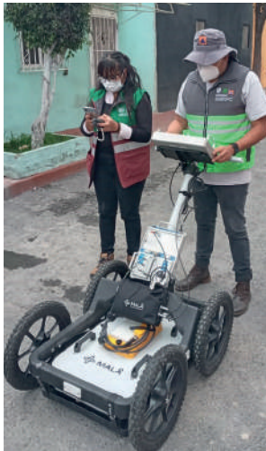
Imagen 14 | Levantamiento de datos con equipo georadar en calle Héroes de la Intervención, colonia Mártires de Tacubaya, SGIRPC.
