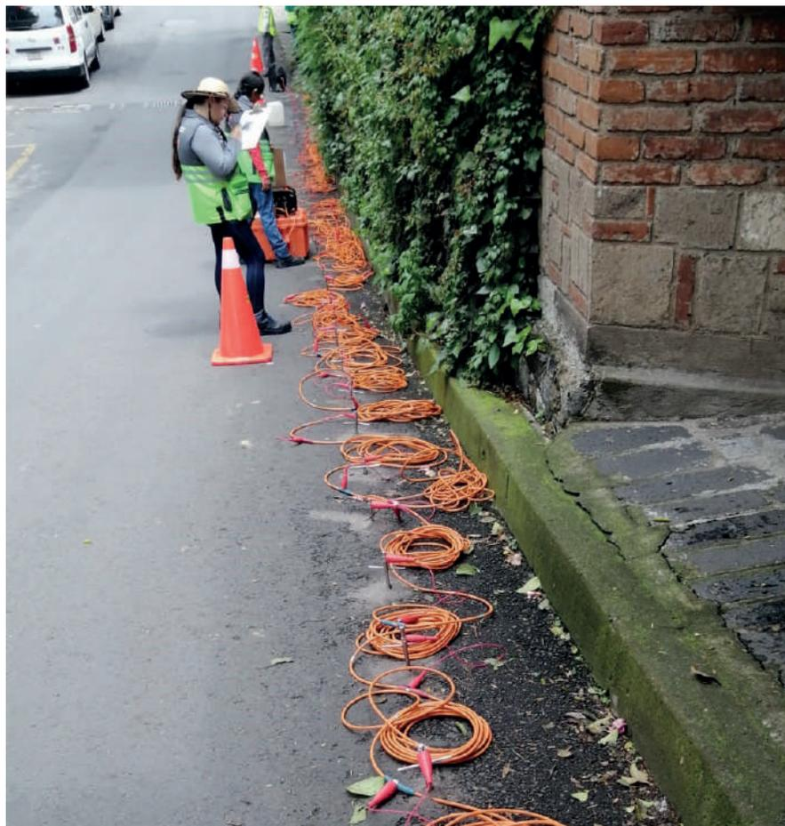
Imagen 2. Levantamiento de Tomografía Eléctrica o Resistivímetro, SGIRPC
