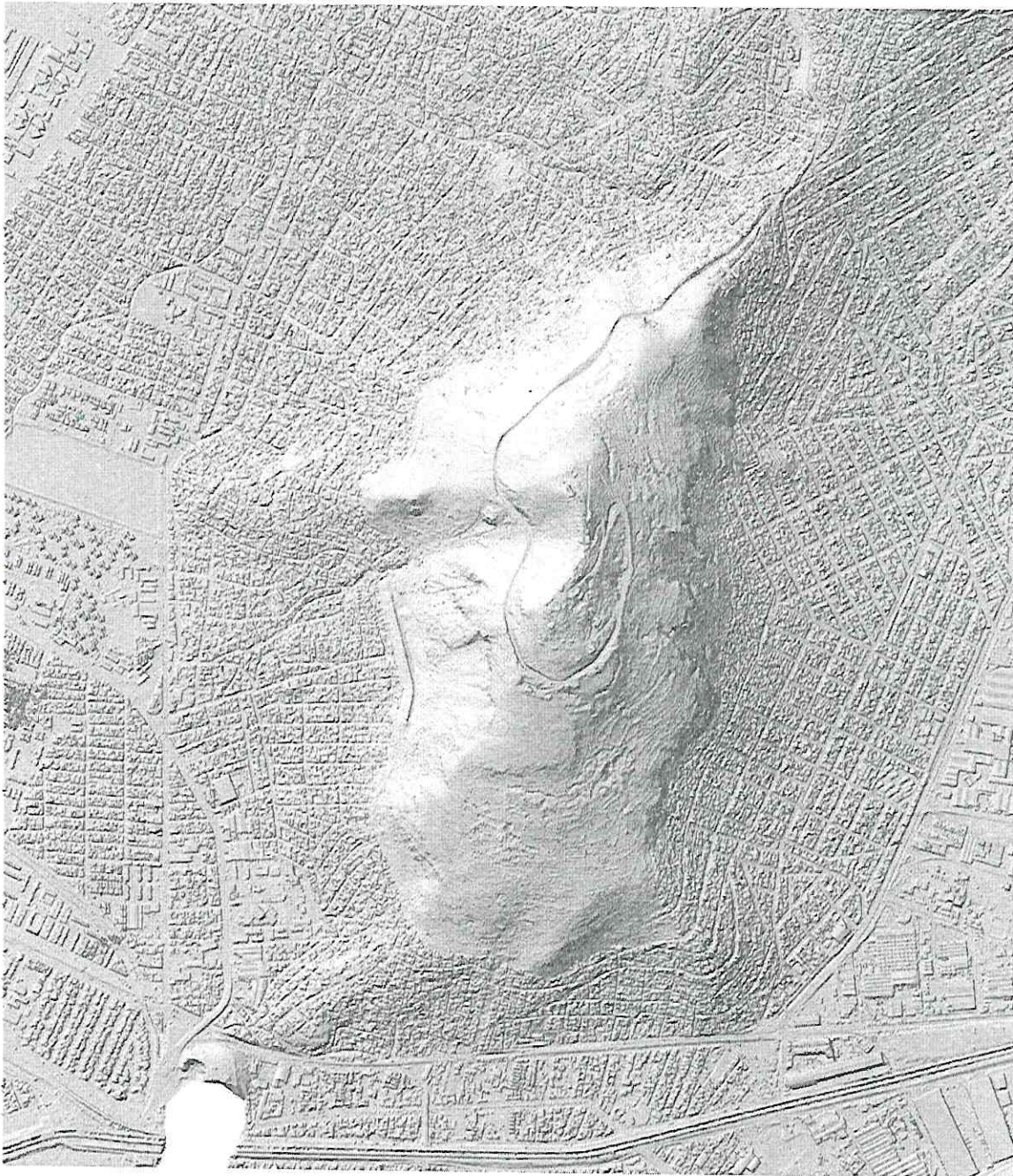
Figura 1. Área de estudio representada por el modelo sombreado que incluye el Cerro del Chiquihuite y parte de la zona plana con fines de cálculo para los modelos. Las dimensiones son de 3 X 3.5 km. Fuente: Información propia, a partir de Lidar aerotransportado (2023).
